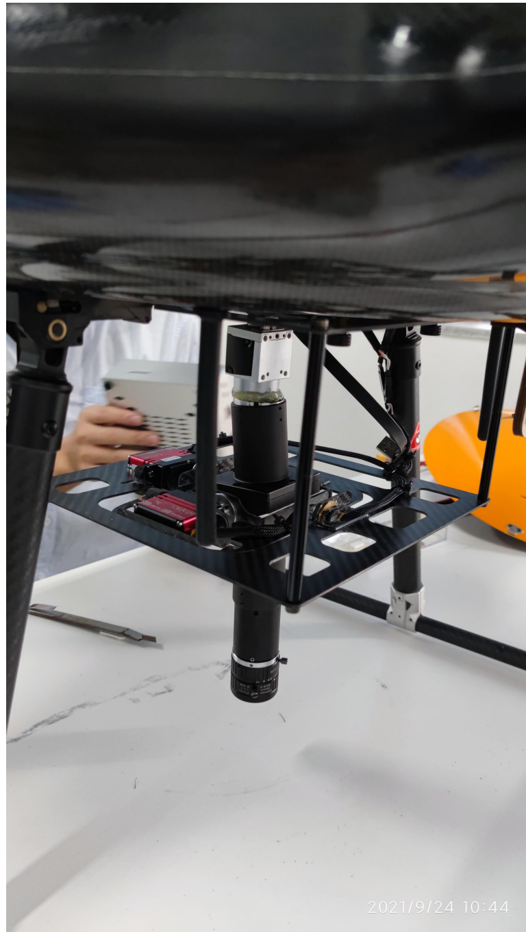
Fig 8 ATH1010 高光谱成像仪
